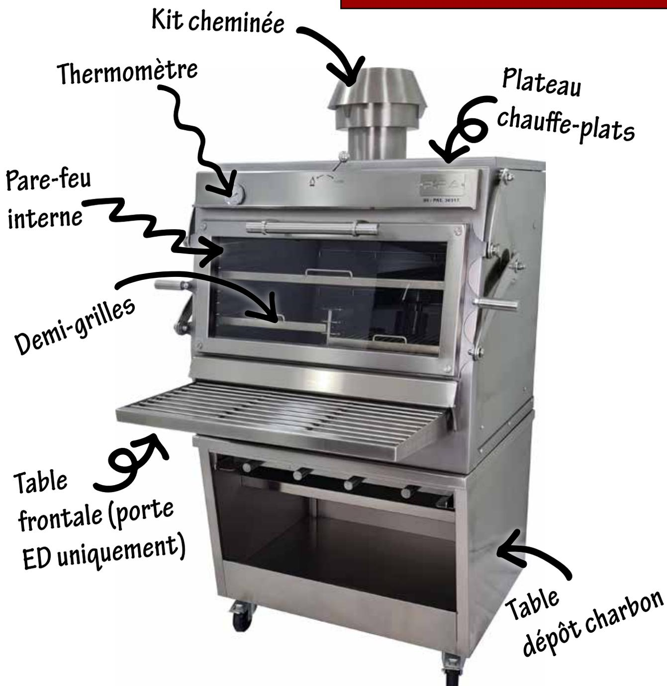
**Caractéristiques :** Température de travail de 180 °C à 350 °C, pare-feu interne, tiroir collecteur de cendres, tiroir collecteur de graisse (sauf modèles 50), option de demi-grilles (sauf modèles 50, 70 et 70 XL), sortie de fumée de 180 mm (modèles 50, 70, 70 XL, 80, 90 et 90 D) ou 210 mm (modèles 120 et 120 D), thermomètre, intérieur en fonte, système PiraCold, régulateur de tirage intégré.
